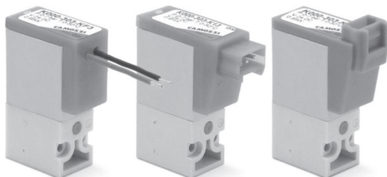
Электропневматические распределители прямого действия Серии К могут работать на воздухе как с распыленным маслом, так и без масла. Они поставляются 3/2 лин./поз. (Н.З.) нормально закрытые или (Н.О.) нормально открытые. Монтажные плиты могут быть как одностенными, так и многостенными. На эти плиты можно монтировать и нормально закрытые и нормально открытые клапаны (но для последних нужен специальный переходник).
